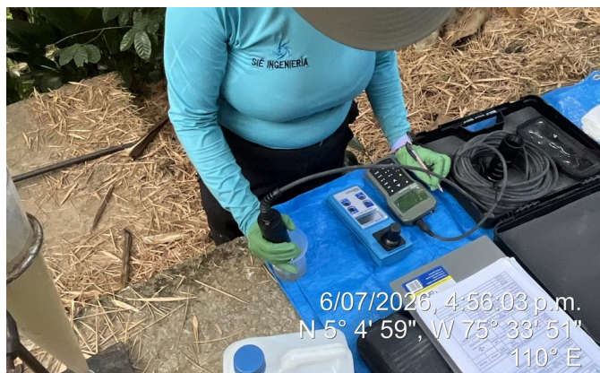
Sonda multiparamétrica en una campaña de campo.
